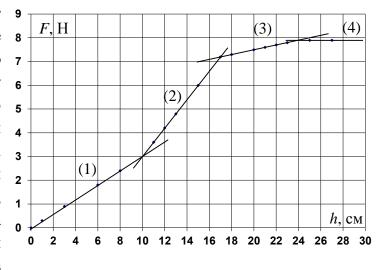
нельзя. В области с h < 24 см самый пологий участок графика третий, следовательно, на нем наименьшая площадь поперечного сечения S. Угловой коэффициент наклона первого участка в три раза больше, следовательно, его сечение 3S = 30 см². На втором участке угловой коэффициент наклона больше в 6 раз, а его площадь сечения 6S = 60 см². Длины цилиндров 10 см, 7 см и 7 см соответственно. Плотность жидкости можно h, см
